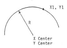
Steuerung verlangt: X1, Y1, XCENTR, YCENTR Lösungen : 1
