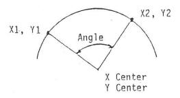
Steuerung verlangt: X1, Y1, X2, Y2, ANGLE Lösungen : 2, A und B
