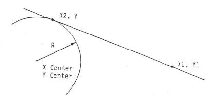
Steuerung verlangt: X1, Y1, XCNTR, YCNTR, RADIUS Lösungen : 2, A und B
