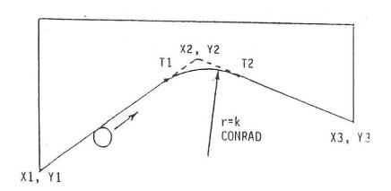
Für die nächste Figur programmiert der Bedienungsmann einen ARC MILL- Event von X1, Y1 nach X2, Y2 mit Fräser-Radius-Kompensation links und einen weiteren ARC MILL-Event von X2, Y2 nach X3, Y3. Bei der Eingabe des ersten ARC MILL- Event fragt die steuerung nach CONRAD, worauf der Wert des tangentialen überganges eingegeben wird. Das System errechnet die Berührungspunkte T1 und T2 und bewegt den Fräser kontinuierlich von X1, Y1 über T1, r=k, T2 nach X3, Y3.
