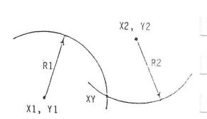
Steuerung verlangt: X1, Y1, R1, X2, Y2, R2 Lösungen : 2, A und B Bei einer Lösung tangieren die Kreise
