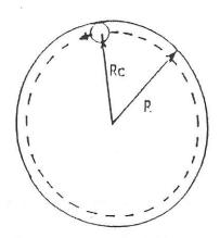
In der vorstehenden Skizze kann der Kreisradius direkt ein gegeben werden. PROTOTRAK versetzt automatisch die Achsen um den Fräserradius.
