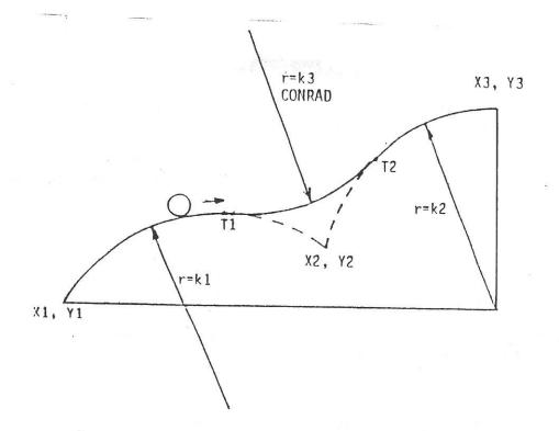
Bemerkung: Für die Innenbearbeitung muss CONRAD immer gleich oder grösser dem Frässerradius sein. Ist CONRAD kleiner als der Fräserradius, so wird CONRAD von der Steuerung ignoriert.
