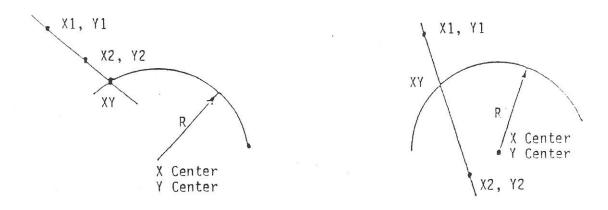
Steuerung verlangt: X1, Y1, X2, Y2, XCENTR, YCENTR, RADIUS
