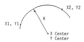
Steuerung verlangt: X1, Y1, X2, Y2, RADIUS Lösungen : 2, A und B
