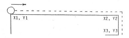
In der vorstehenden Skizze bewegt sich der Fräser von links nach rechts von Punkt X1, Y1 nach X2, Y2 und X3, Y3. Die Koordinaten können direkt eingegeben werden, der Werkzeugradius braucht nicht berücksichtigt zu werden.
