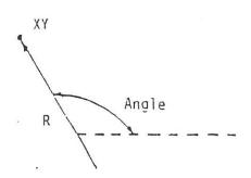
Steuerung verlangt: RADIUS, ANGLE (der Winkel ist immer positive von 3 Uhr aus anzugeben)
