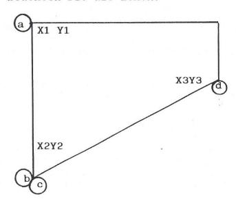
Bei der Bearbeitung der vorstehnden Kontur mit DO ONE, MILL müssen Sie vor dem Starten der zweiten Bewegung von c nach d das Werkzeug anheben, da sonst durch die Fräserkorrektur, die vor dem Ablfauf automatisch durchgeführt wird, die Ecke der Koordinate X2, Y2 wegefräst wird.
