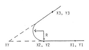
Steuerung verlangt: X1, Y1, X2, Y2, X3, Y3, RADIUS
