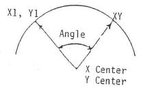
Steuerung verlangt: X1, Y1, XCENTR, YCENTR, ANGLE Lösungen : 2, A und B
