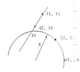
Steuerung verlangt: X1, Y1, X2, Y2, X3, Y3, X4, Y4, RADIUS Lösungen : 4, A, B, C und D
