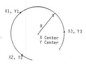
Steuerung verlangt: X1, Y1, X2, Y2, X3, Y3 Lösungen : 1
