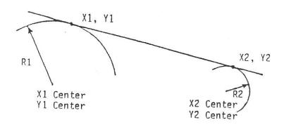
Steuerung verlangt: X1CNTR, Y1CNTR, R1, X2CNTR, Y2CNTR, R2 Lösungen : 2, A und B für jeden Punkt
